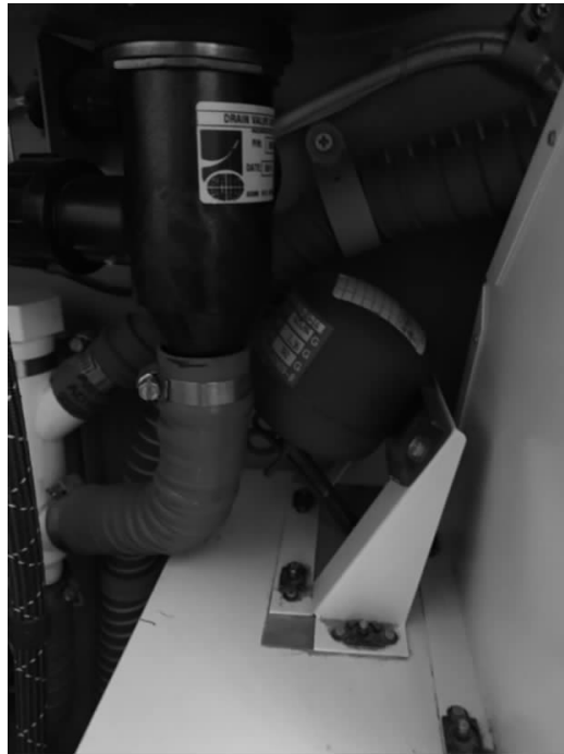
图 1-15 洗手间灭火装置的安装位置
