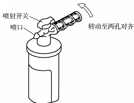
图 1-13 水灭火瓶的结构
