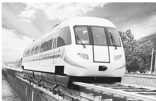
图 1-13 国内首列实用型中低速磁浮列车
