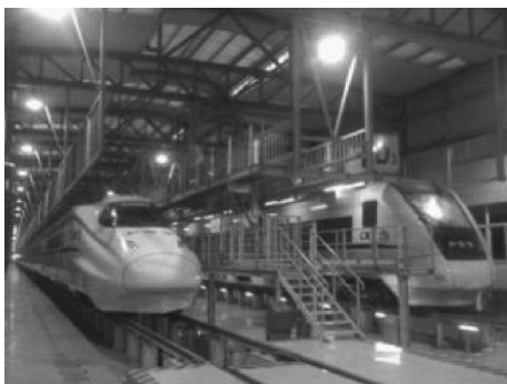
图1-20 双周、双月检库立体检修平台
