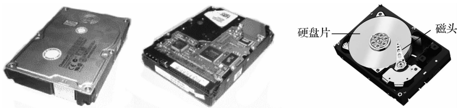
图 1-3 硬盘正面、反面及内部结构
