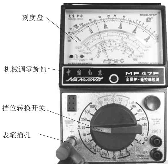
图 2-9 指针式万用表的面板说明与挡位选择
