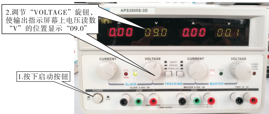
图 2-13 调节直流稳压电源的输出
