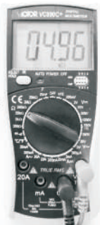
图 2-27 调节万用表的电阻测量挡位
