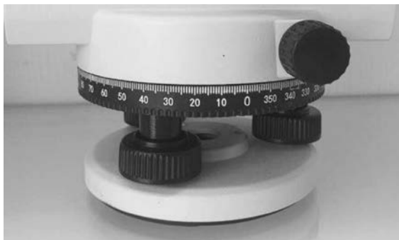
图 1-7 南方 DS3 水准仪的基座
