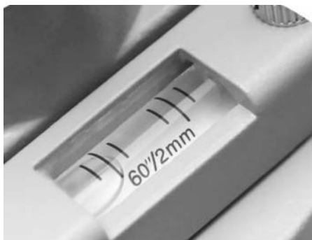
图 1-5 南方 DS3 水准仪的管水准器
