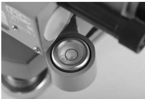
图 1-6 南方 DS3 水准仪的圆水准器
