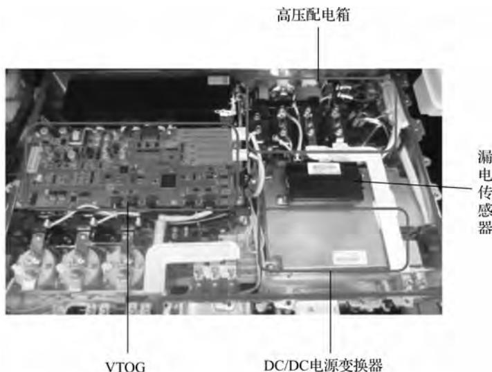
图 2-1 高压电控总成
