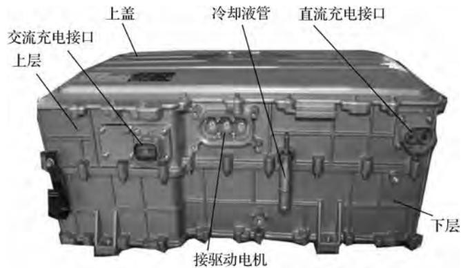
图 2-2 高压电控总成的正面接口示意图
