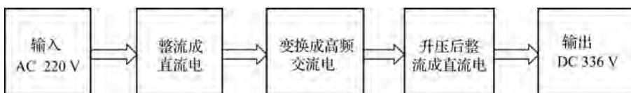
图 2-8 AC/DC 变换拓扑结构工作原理框图
