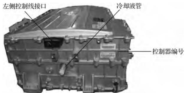
图 2-4 高压电控总成的左侧接口示意图
