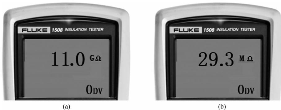
图 1-32 动力电池绝缘阻值检测结果
