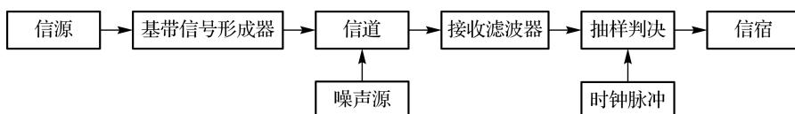
图 1-4 数字基带传输通信系统模型
