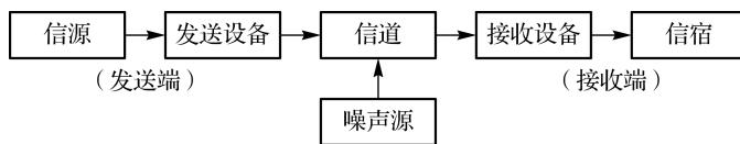
图 1-1 点对点通信系统的一般模型
