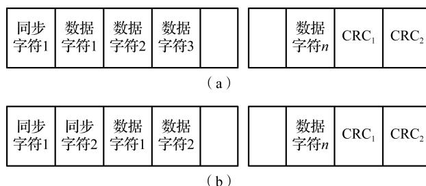
图 1-9 同步通信的字符帧格式
