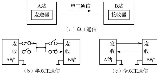
图 1-6 单工通信、半双工通信和全双工通信
