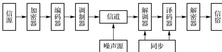
图 1-3 数字频带传输通信系统模型
