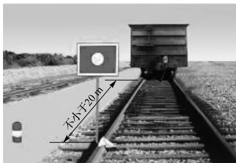
图 1-5 带有脱轨器的移动信号牌及防护距离
