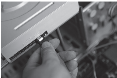
图 1-41 连接硬盘 SATA 接口的电源线
