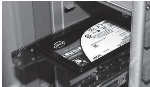
图 1-40 安装固态硬盘
