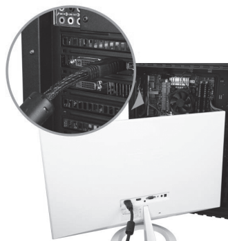
图 1-46 连接显示接口
