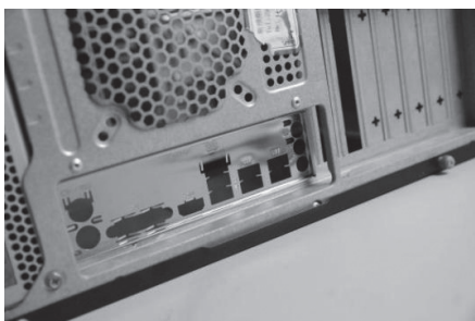
图 1-28 观察 I/O 端口位置与接口挡板
