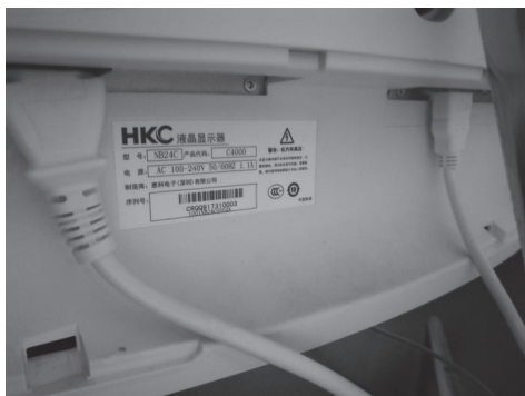
图 1-45 连接显示器电源线
