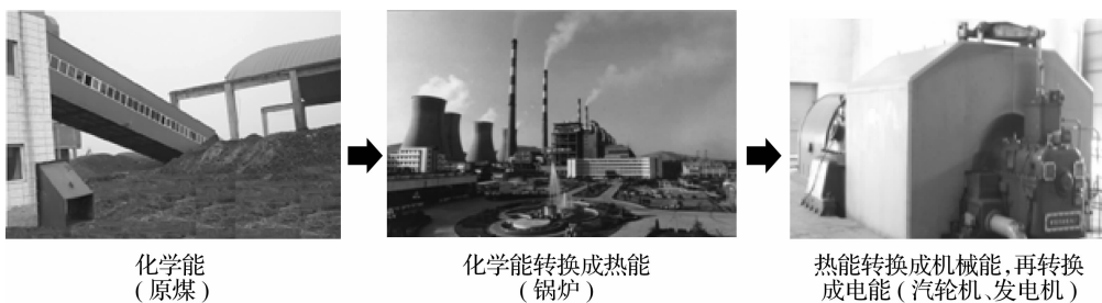
图 1-6 火力发电能量转换过程
