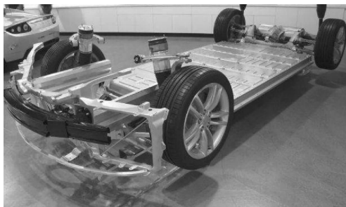
图 2-12 电池包模块化设计
