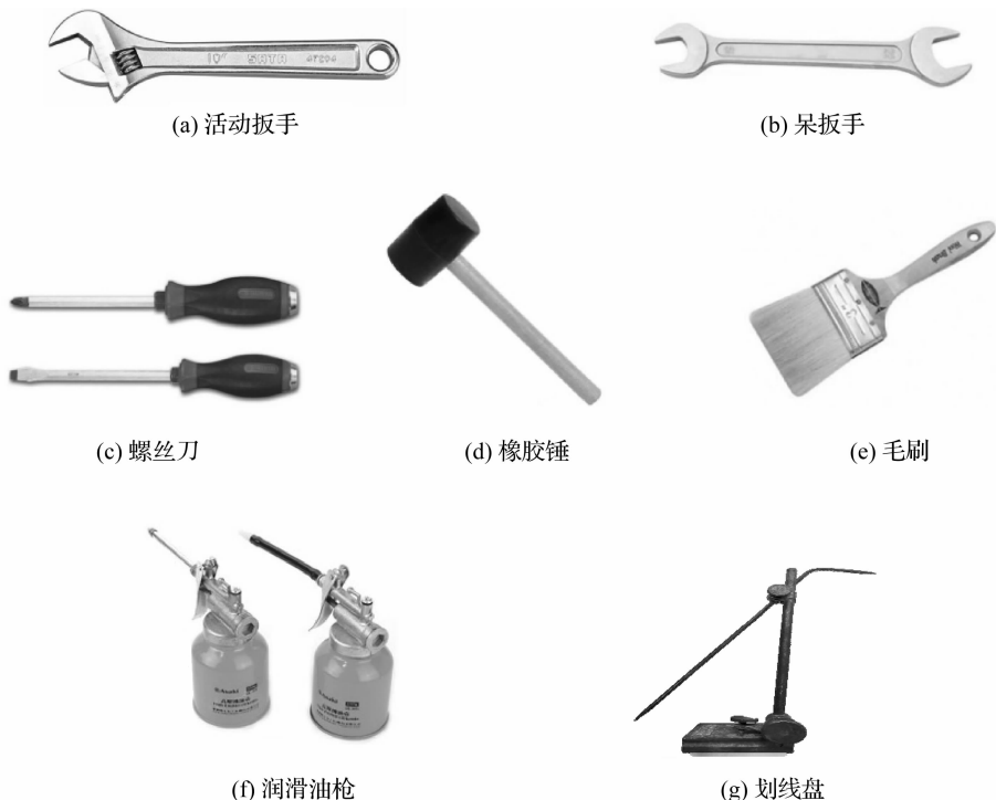
图 1-10 铣工常用工具
