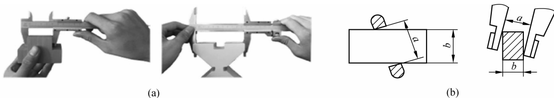
图 1-5 测量外轮廓尺寸的方法示意图
