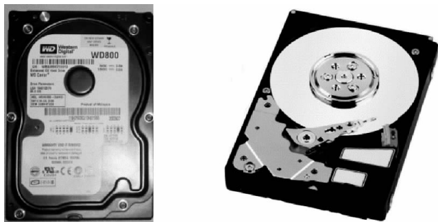
图 1-5 硬盘的外形及结构
