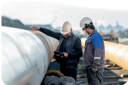
图2-2-4 用超声波检测金属构件
