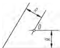
图 2-19 两直线间的圆弧连接作图步骤 1
