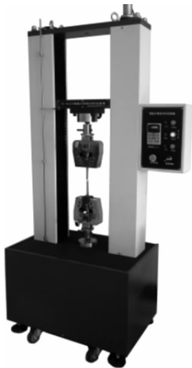
图 1-9 万能材料试验机的外形
