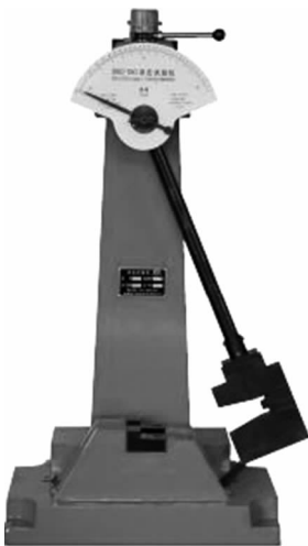
图 1-16 冲击韧性试验机结构简图
