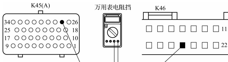
图 2-43 电流霍尔传感器+15V 电源线路的检测
