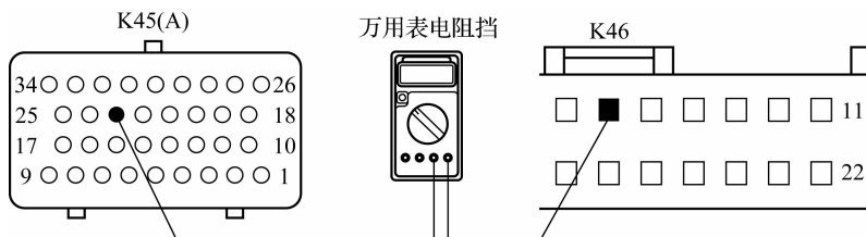
图 2-41 DC 预充接触器控制信号线路的检测
