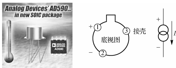
图 2-25 AD590 的外形、引脚排列和电路符号
