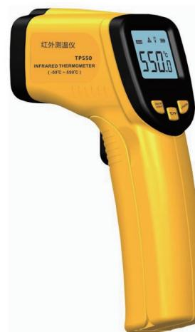
图 1-13 红外线测温仪
