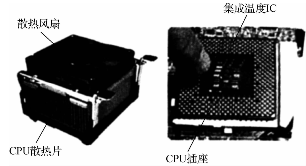
图 1-4-7 CPU 散热风扇控制系统
