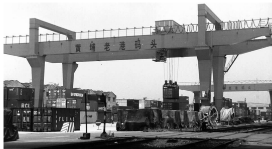
图 3-10 双主梁龙门起重机结构
