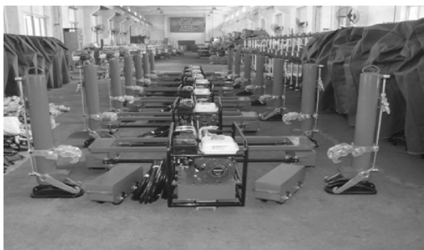
图 2-34 道岔铺换设备
