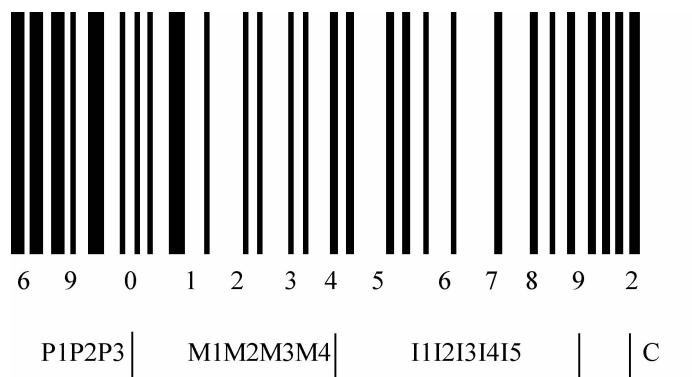
图 3-1 EAN-13 码的构成
