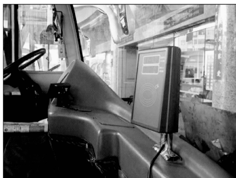
图 3-3 装在公交车上的射频读卡器
