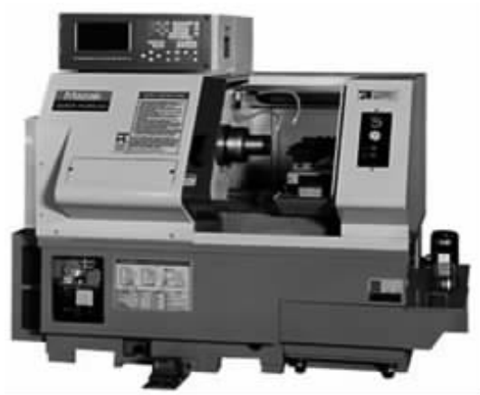
图 2-1 通用 X、Z 二轴控制(卧式)
