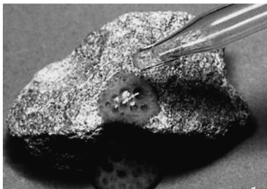
图 2-11 方解石遇冷稀盐酸起泡
