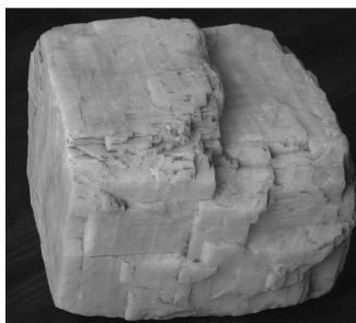
图 2-9 方解石三组完全解理
