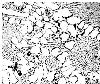
图 2-22 Pb-Sn 二元合金的过共晶组织
