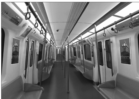
图 1-3 某地铁车辆的客室内装
