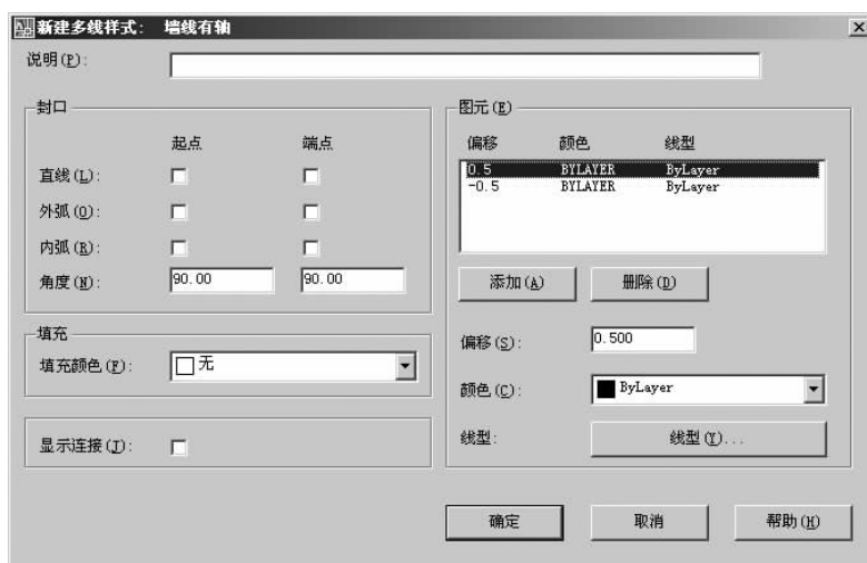
图 3-21 “新建多线样式: 墙线有轴”对话框
