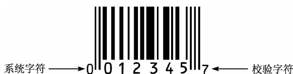
图 2-6 UPC-E 商品条码结构示例
