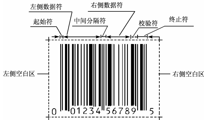
图 2-5 UPC-A 商品条码符号结构示例
