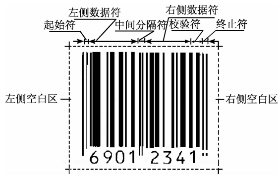
图 2-4 EAN-8 商品条码符号结构示例
