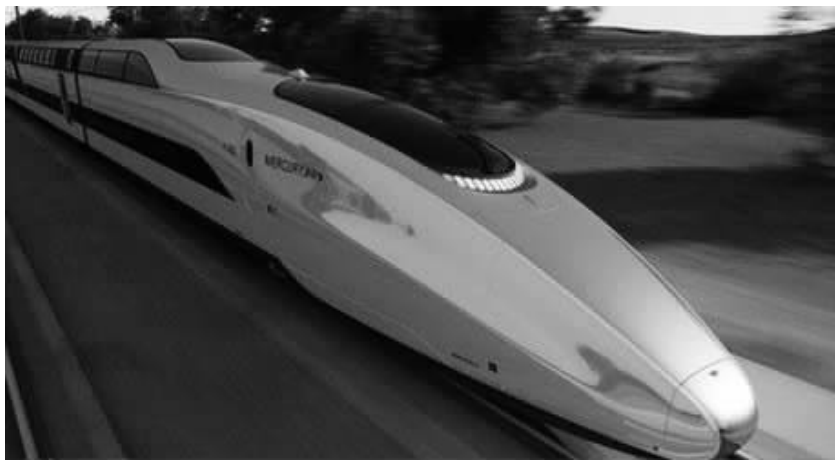
图 3-1 列车流线型的车体外形
