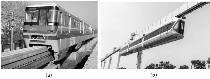
图 1-6 单轨交通 (a)跨座式 (b)悬挂式
