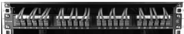
图 1-12 双绞线配线架正面实物图
