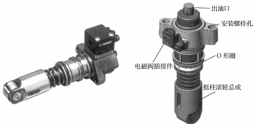
图 3-27 电控单体泵燃油喷射系统的结构
