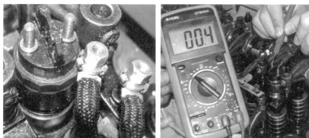
图 3-53 电磁喷油器的静态电阻的检测
