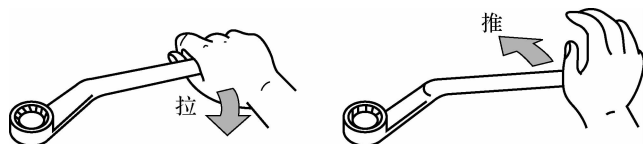
图 2-3 梅花扳手的正确使用方法
