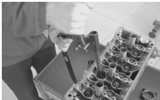
图 2-22 气门弹簧拆装架的使用
