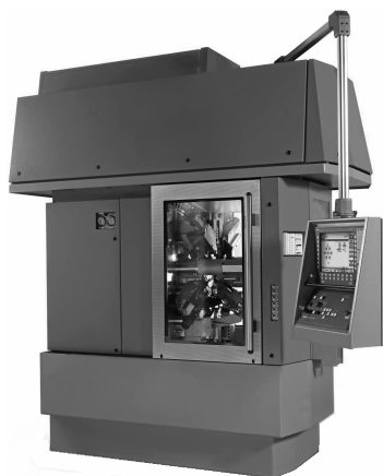
图 1-8 多轴控制的数控车床
