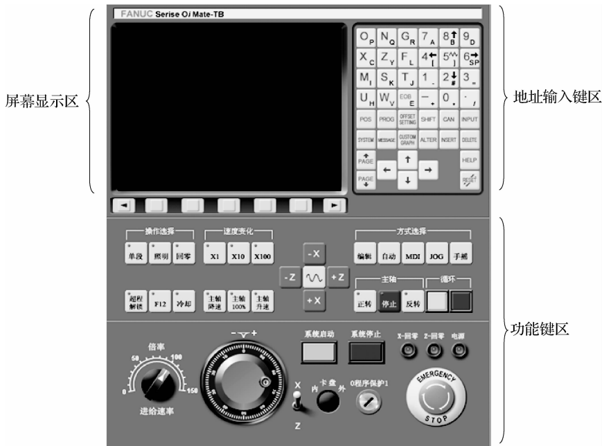
图 1-17 数控车床的操作面板
