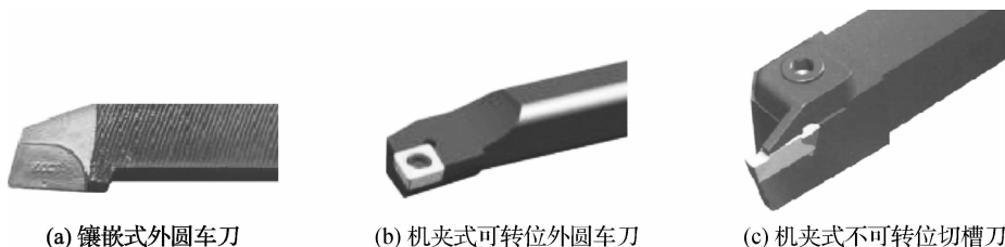
图 1-12 数控车削刀具的结构
