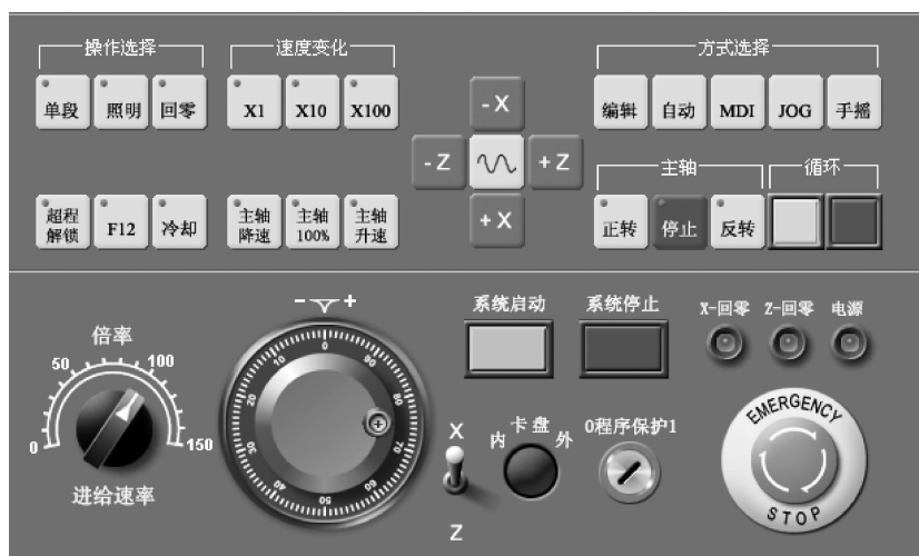
图 1-19 数控车床的功能键区
