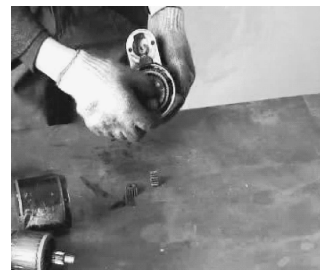
图 3-23 行星齿轮拆卸
