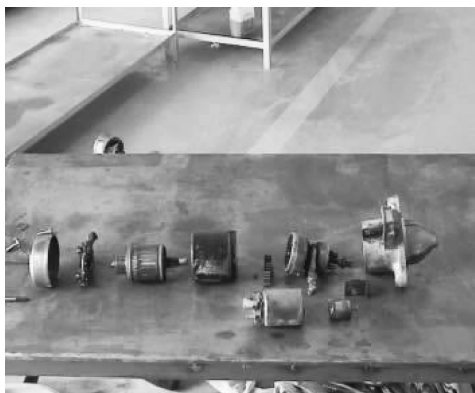
图3-26 起动机拆卸分解完成
