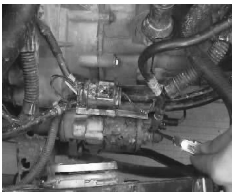
图 3-38 起动机电磁开关检查(正常状态)
