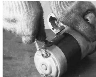
图 3-17 轴承后端盖紧固螺钉拆卸(2)
