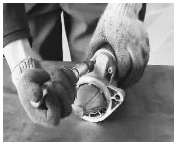
图 3-14 电磁开关紧固螺钉拆卸
