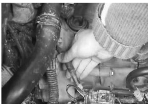
图 3-36 起动机搭铁线检查
