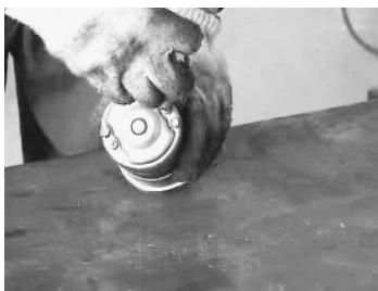
图 3-16 轴承后端盖紧固螺钉拆卸(1)
