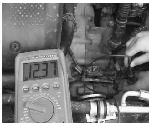
图 3-39 起动机起动信号检查(正常状态)
