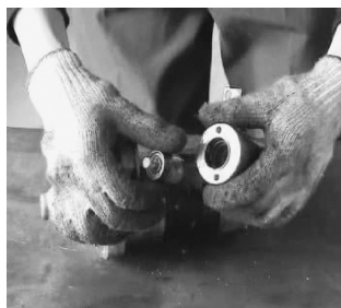
图 3-15 电磁开关拆卸完成
