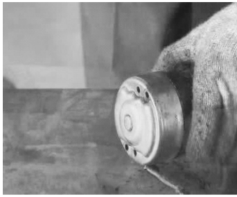
图 3-18 后端盖紧固螺钉拆卸完成
