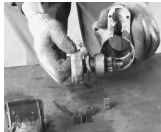
图 3-25 单向离合器总成拆卸完成
