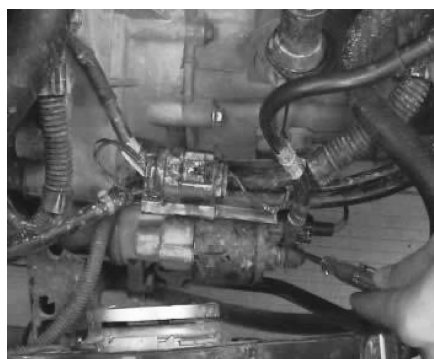
图 3-37 起动机电磁开关检查
