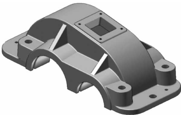
图 5-5 减速器箱盖的基本结构
