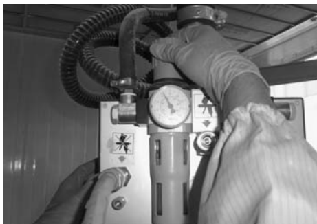
图 8-35 调整打磨机工作压力
