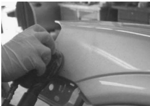
图 8-80 打磨损伤部位
