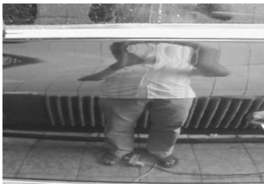
图 8-22 精细抛光后的涂面
