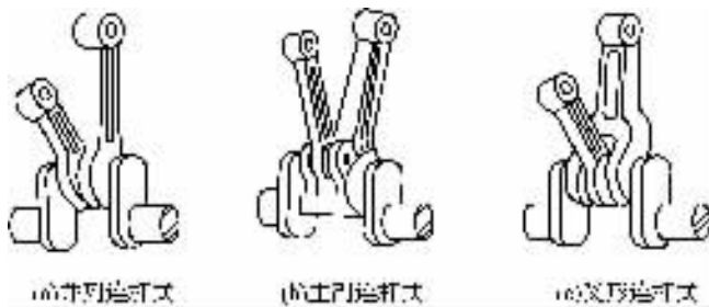
图 2-28 V 型发动机连杆的结构形式
