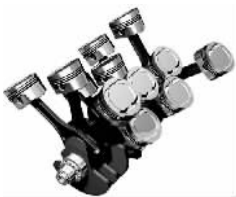
图 2-6 W12 发动机汽缸排列形式
