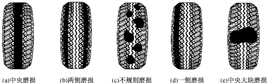
图 11-30 轮胎的非正常磨损
