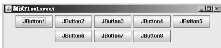
图 7-5 FlowLayout 流布局拖动窗口长度后的效果
